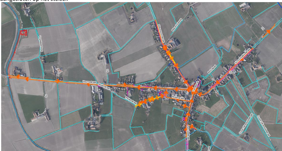
Figuur 92: RWA afwateringsrichting Pervijze (Bron achtergrondlagen: Informatie Vlaanderen & Fluvijs; [3])
