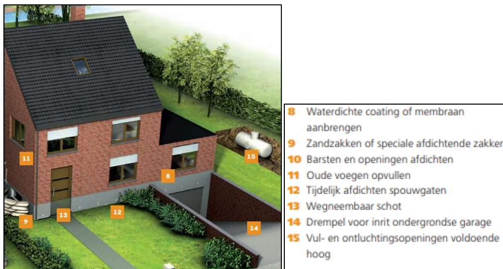
Figuur 87: Overstromingsgevoelig bouwen bij een bestaande woning (Bron: Integraal Waterbeleid; [68])
