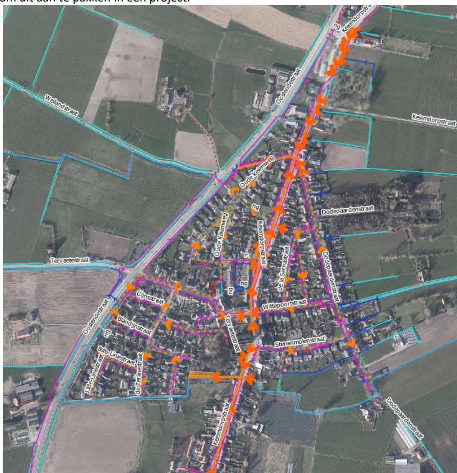
Figuur 97: RWA afwateringsrichting Keiem (Bron achtergrondlagen: Informatie Vlaanderen & Fluvijs; [3])
