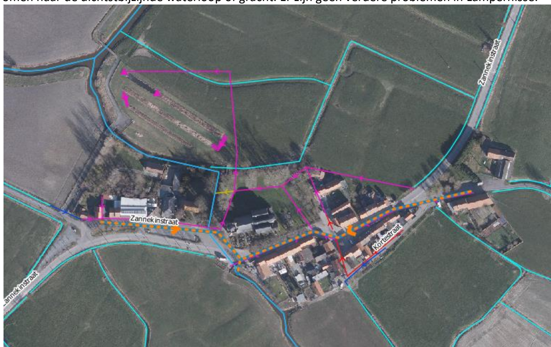
Figuur 94: RWA afwateringsrichting Lampernisse (Bron achtergrondlagen: Informatie Vlaanderen & Fluviu; [3])
